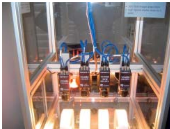
Frontansicht der Demoanlage: Links zwei Color-Smart Kameras zur Kontrolle des Aufdrucks, daneben die Passermarken-Vermessung, ganz rechts die Verifikation eines Datumsaufdrucks
