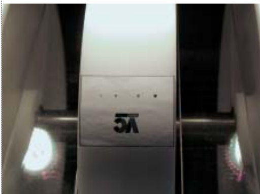
Nahaufnahme der verwendeten Passermarken auf dem Laufrad, das die Marken auf bis zu 10 m/s beschleunigen kann
