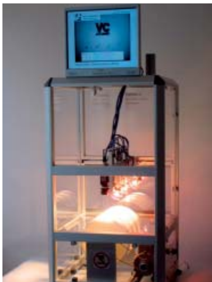
Demonstrationsanlage zur Passermarken-Vermessung in der Druckindustrie
