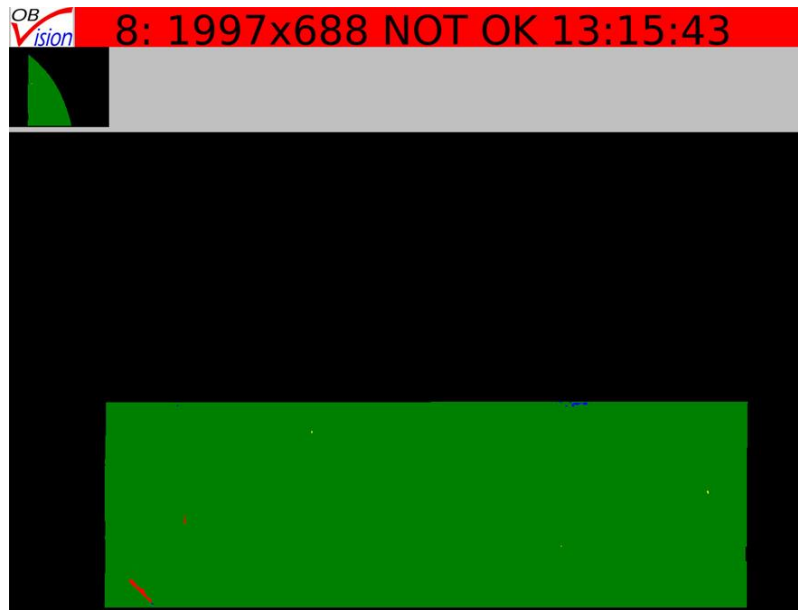
Bild 2: Screenshot der Fehleranzeige: starke Kratzer sind rot markiert (unten links)
