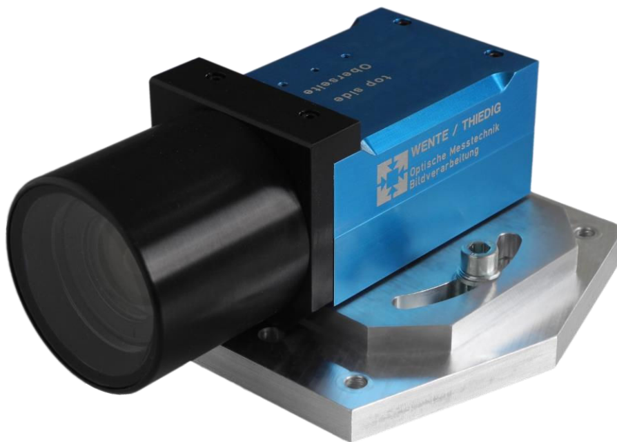
Bild 2: Die optische Positionskontrolle erfolgt mit jeweils zwei Smart Kameras pro Schwergutbehälter.
